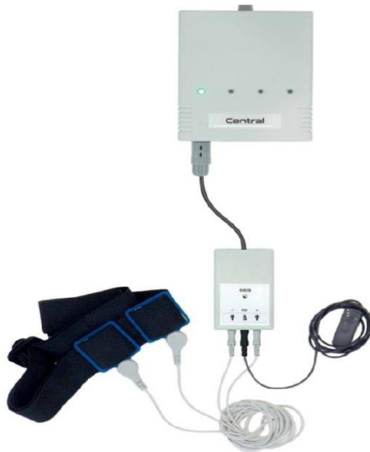
Рис.3 Цифровая лаборатория ViTronics Studio (сенсор ЭЭГ)
